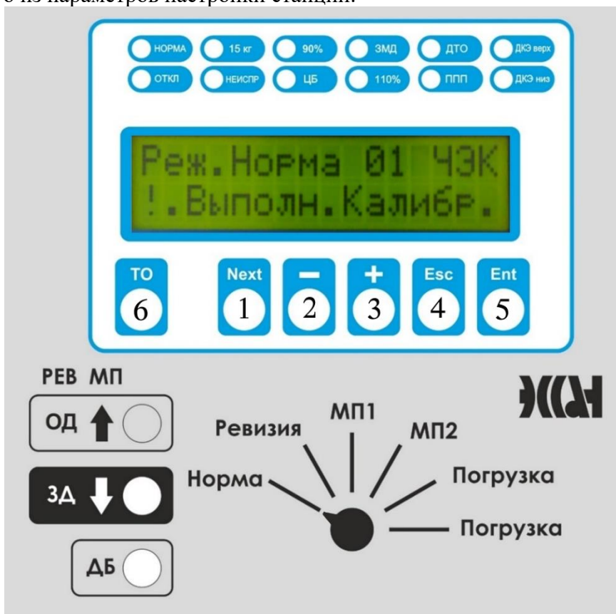
Рисунок 18. Клавиатура станции. 1 - кнопка «Next», 2 - кнопка «-», 3 - кнопка «+», 4 - кнопка «Esc», 5 - кнопка «Ent», 6 - кнопка «ТО».
