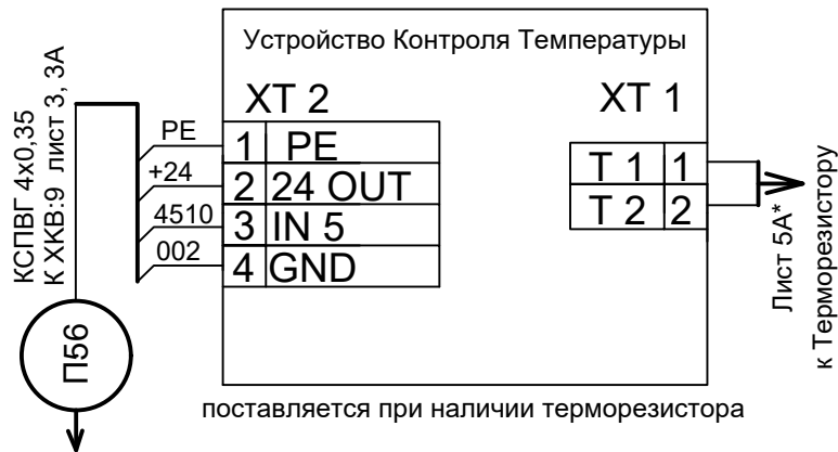
Схема подключения панели ЧП для асинхронной лебедки
