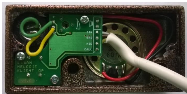
Рисунок 6. Вид панели Клиента ОП при снятой задней крышке.
