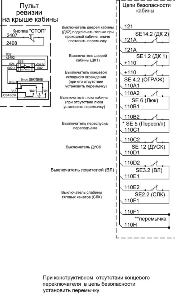
\* Подключать при установке концевого переключателя.
