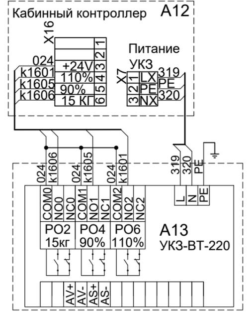
\* В отсутствие трансформатора AC 220/24 подключать к разъёму X27 кабинного контроллера, к контактам 1 и 2
