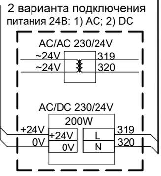
Подключение привода дверей Портал/КМ-10 к контроллеру кабины (проходная кабина)
