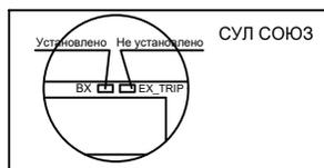
\* Если на плате фильтра питания запаян резистор в положении Bx, подключить провод EX Trip ко входу ПЧ S6 вместе с проводом BX.
