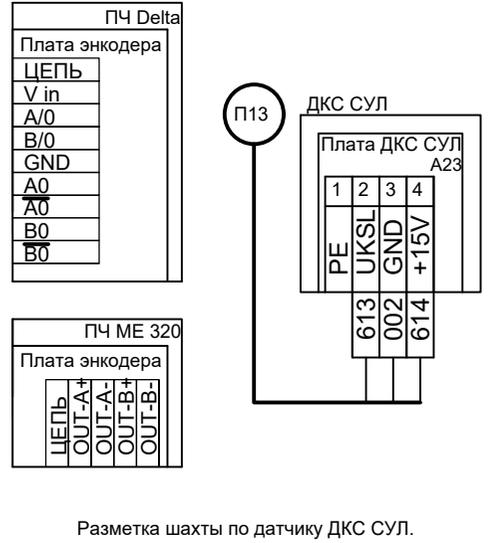
Подключение источника импульсов к плате УКСЛ
