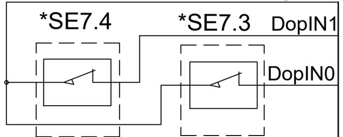
Контроль сработки упоров: противовеса кабины
