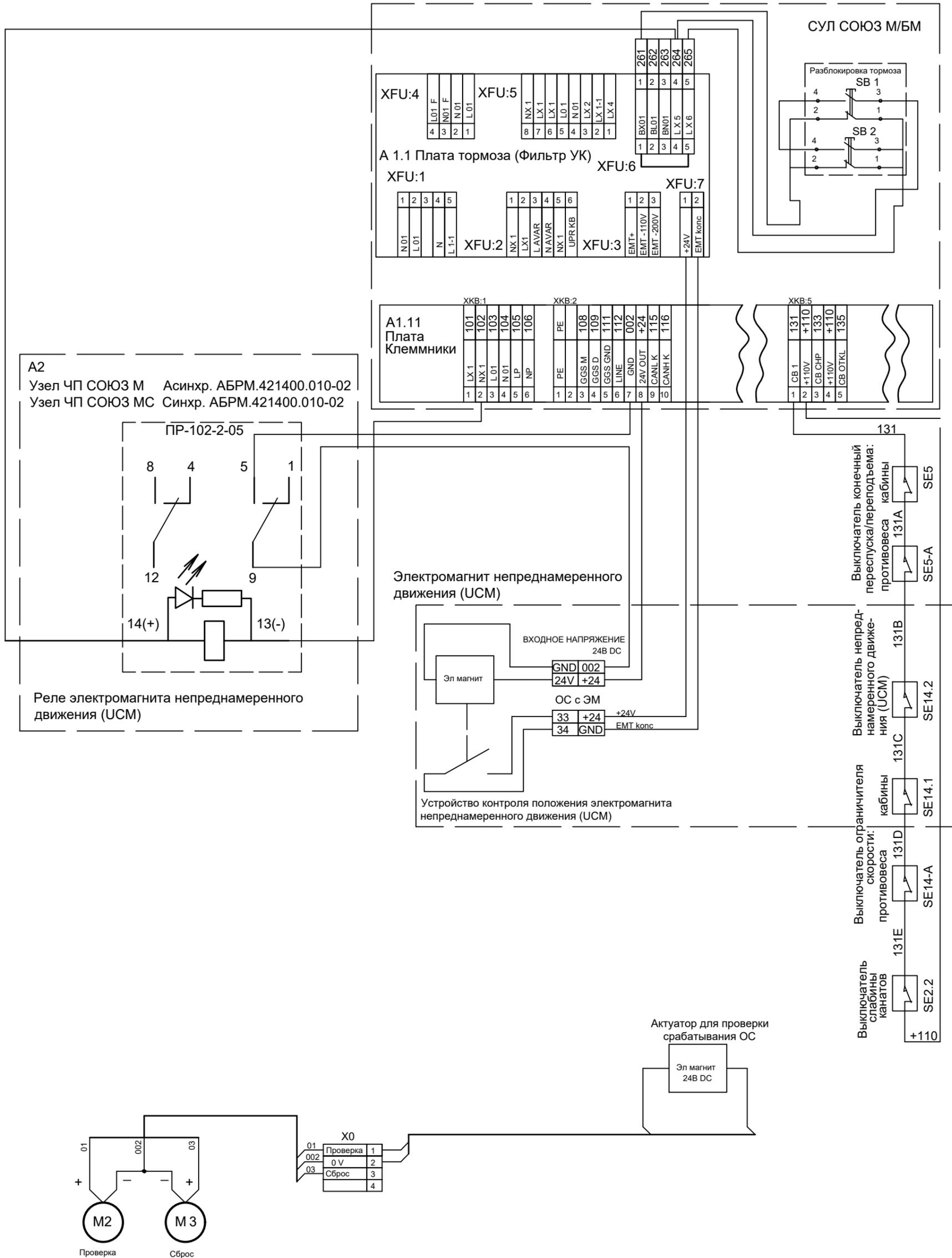
Схема подключения Ограничителя Скорости по ГОСТ 33984.1-2016
