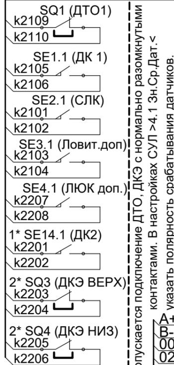
! Допускается подключение ДТО, ДКЭ с нормально разомкнутыми контактами. В настройках СУЛ >4.1 Зн. Ср. Дат.< указать полярность срабатывания датчиков.
