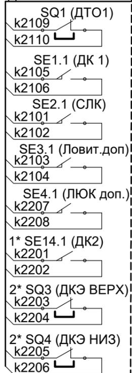
! Допускается подключение ДТО, ДКЭ с нормально разомкнутыми контактами. В настройках СУЛ >4.1 Зн. Ср. Дат.< указать полярность срабатывания датчиков.
