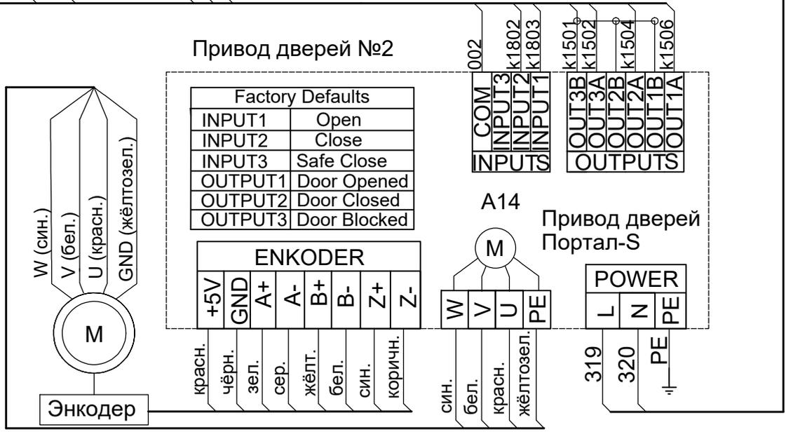
Подключение привода дверей KM-30S к контроллеру кабины (проходная кабина)
