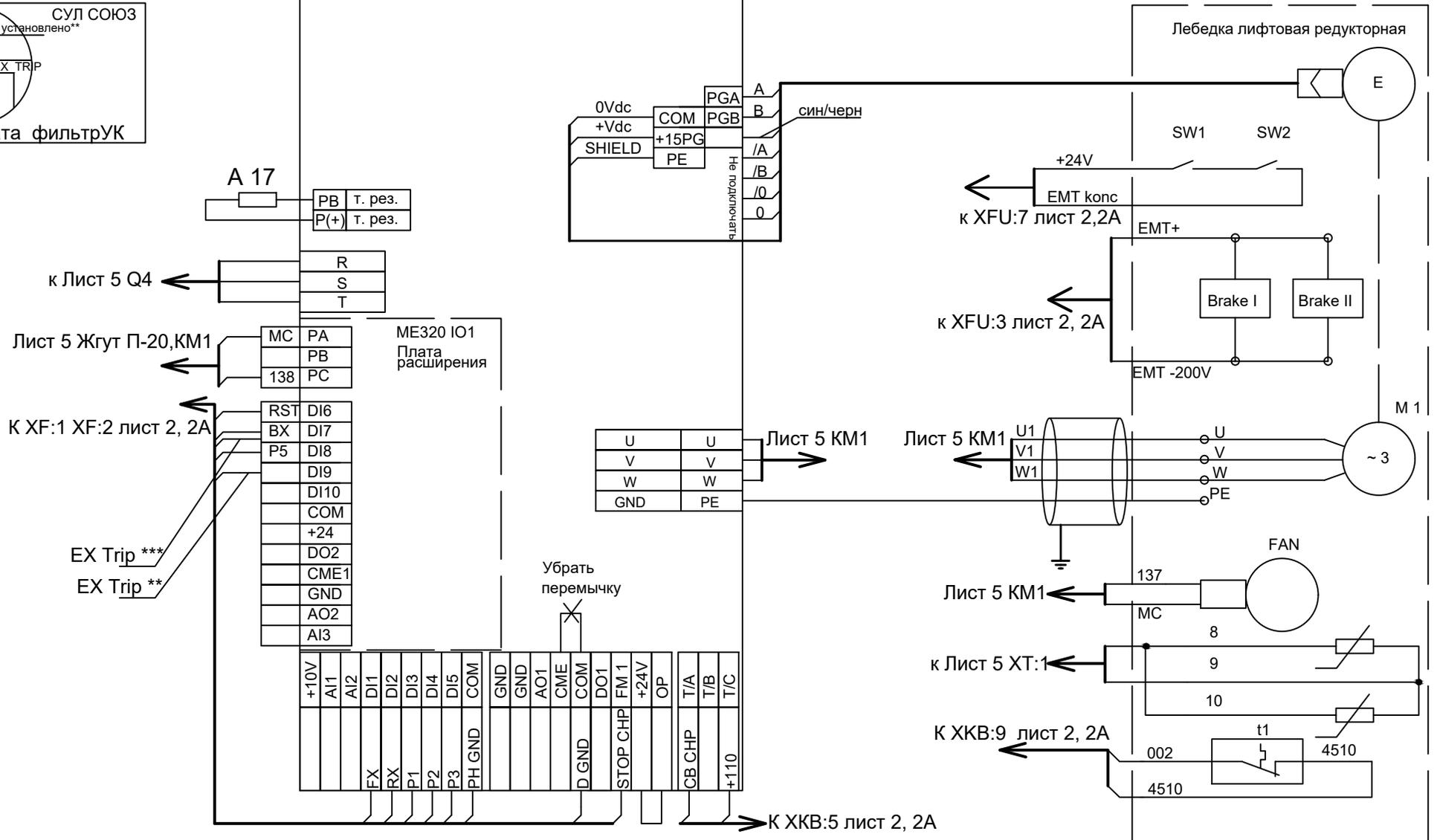
\*\*Если на плате фильтра питания запаян резистор в положении EX Trip, подключить провод EX Trip ко входу ПЧ Di 9. К Di 7 не подключать. Настроить F4-09 -107.
