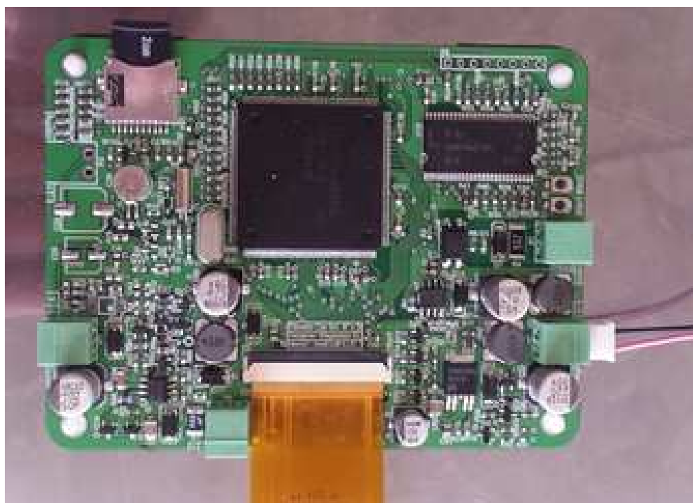
Рис.4. Пример правильного подключения дисплея к печатной плате.
