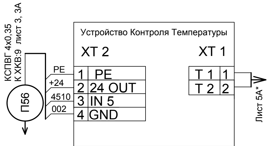
Схема подключения панели ЧП для асинхронной лебедки
