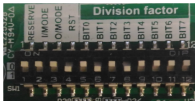
Рис.2. Положение DIP- переключателей на плате PGN-01.
