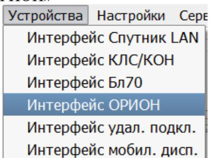
2) В появившемся окне «Интерфейс ОРИОН» в окне «Порт» набираем номер порта, полученный от провайдера, обслуживающего сеть подключения программы ЦПД «Океан 4» (пример ввода порта представлен на рисунке ниже)
