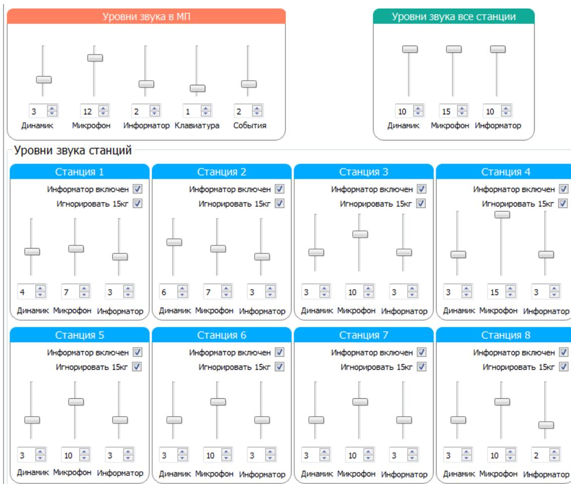
Звуковой информатор может быть включен для каждого лифта отдельно.
