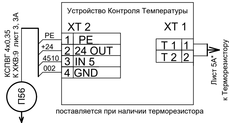
Схема подключения панели ЧП для асинхронной лебедки
